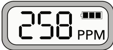
Das Display zeigt die CO-Konzentration 258 in PPM (Parts per Million) und den Batteriestand (voll in diesem Fall).
